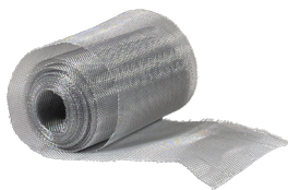
Skär av brandstoppet till passande längd. Bandet skall passa snävt mellan takstolarna. Häfta, skruva eller spika fast brandstoppet med 4 fästelement per meter
